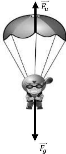
Slika 7: Prikaz sile upora in gravitacijske sile na padalca.
